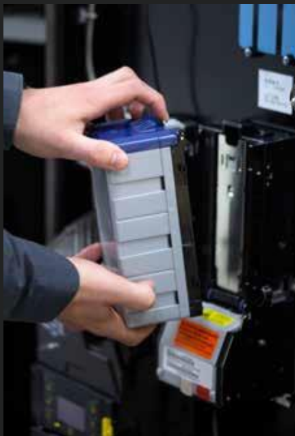
Drücken Sie den Drucktaster oberhalb der Kartusche und ziehen Sie die Box ab.
